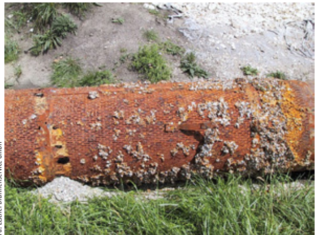
Abb. 1 – Korrosionsschäden am Ausbau
