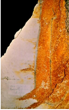
Zwei mal Filterkuchen bei doppelter Kiesschüttung
