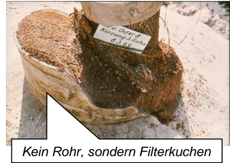
Zwei mal Filterkuchen bei doppelter Kiesschüttung
