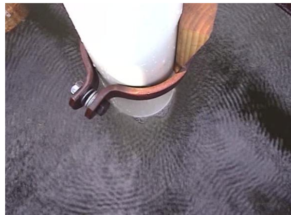
Abb.: Druckwellen-Impulse erzeugt durch das JET-Master® Verfahren
