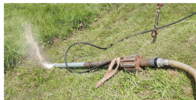
Bild 3: Strahlsauger
