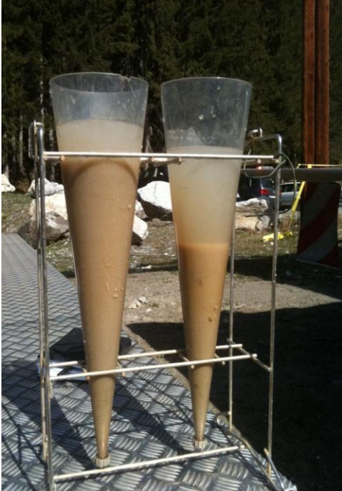
Entfernte Spülung und Unterkorn
