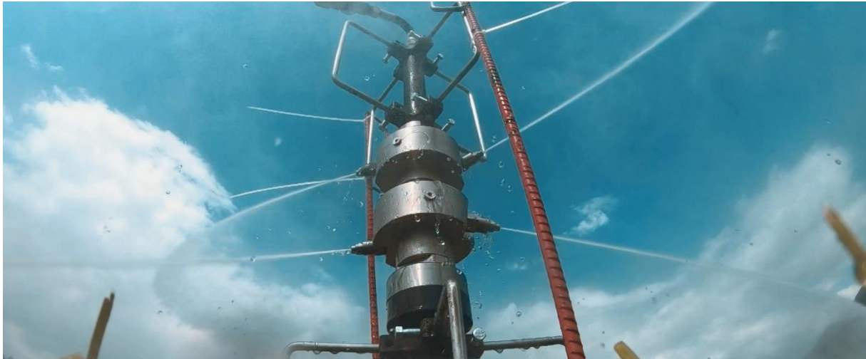
Abbildung 5: Beim Druckwellenimpuls-Verfahren mit Wasserhochdruck arbeitet effektiv und nachhaltig (hier beim Probelauf mit sehr geringem Druck).
