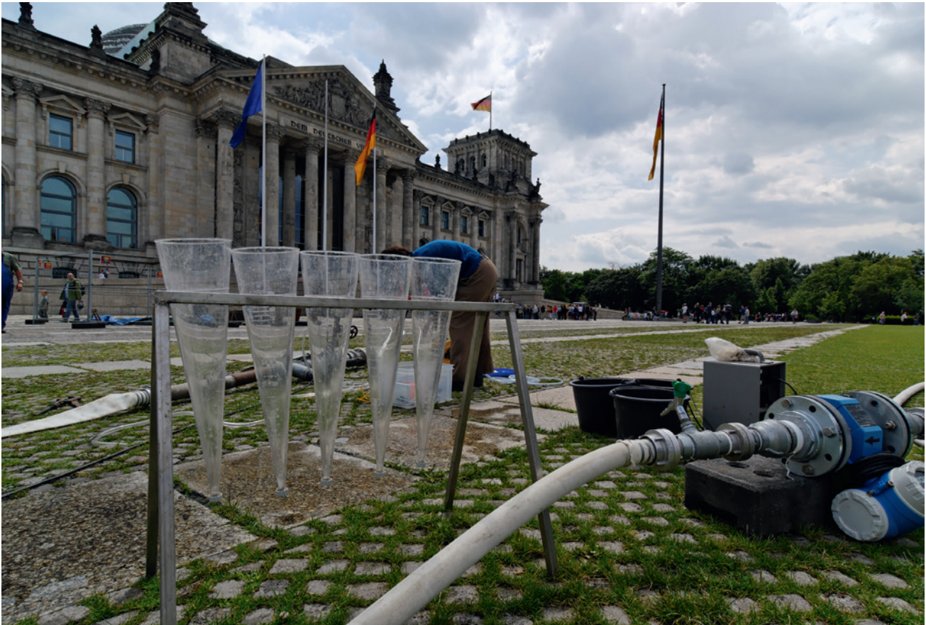
Abb. 3 Imhoff-Trichter zur Feststoffmessung bei einer Brunnenmaßnahme vor dem Berliner Reichstag
