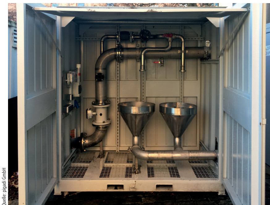
Abb. 6 Container mit integrierter Siebmessung für eine kontinuierliche Feststofffassung
