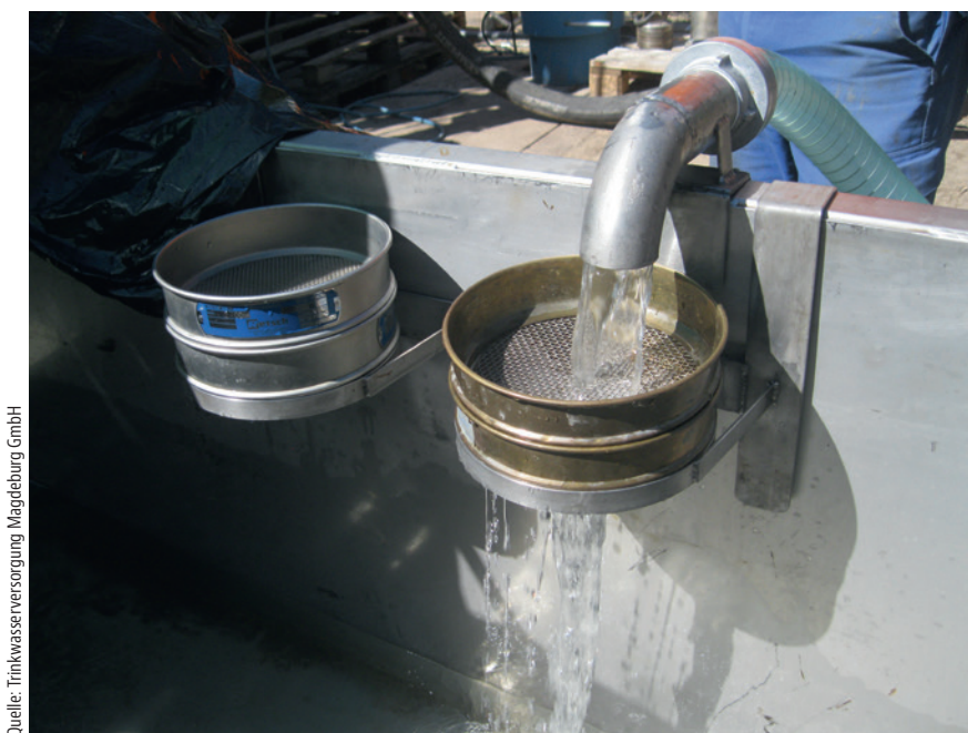
Abb. 7 Baustellentaugliche Variante für eine kontinuierliche Feststofffassung aus dem Teilstrom
